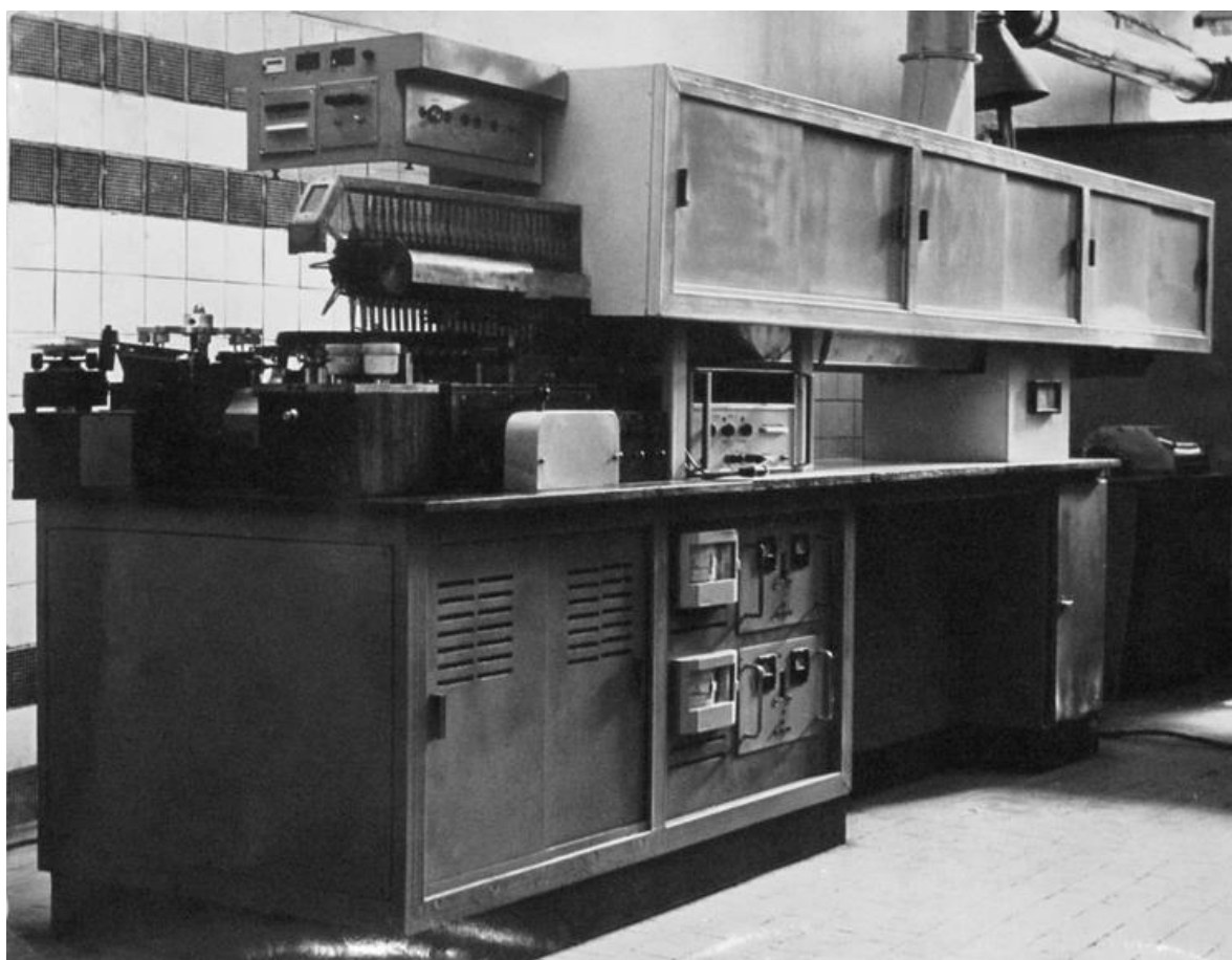
ЛАМ - автоматическая линия металлизации КМ6
